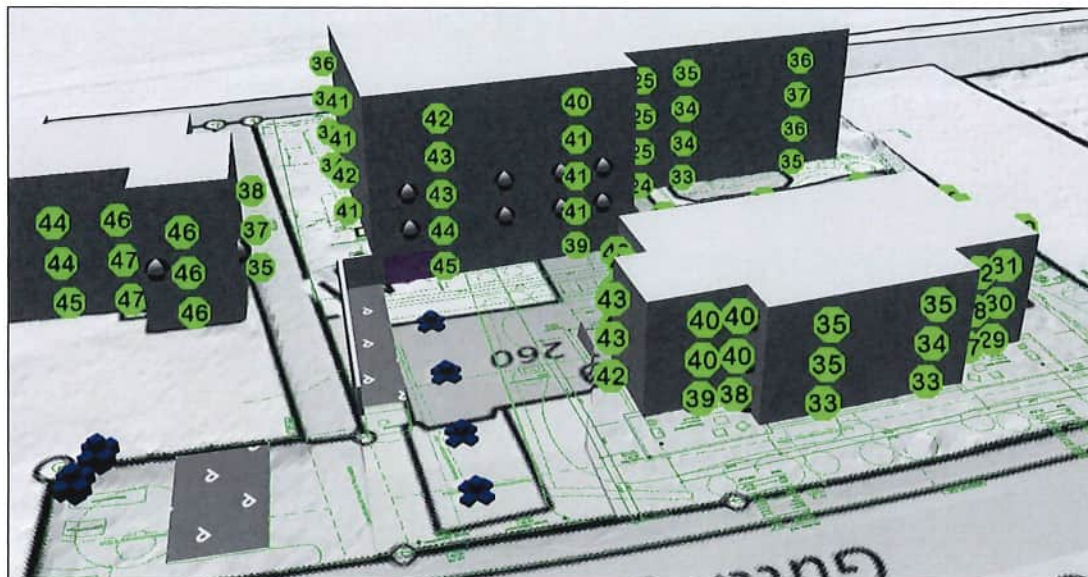
Abbildung 10 3-D Ansicht mit Lage der Emissionspunkte der Zufahrt und Tiefgaragenportal, Besucherparkplätze und Luftein- und Auslässe Wärmepumpe sowie Fassadenpegel im Zeitraum Nacht
